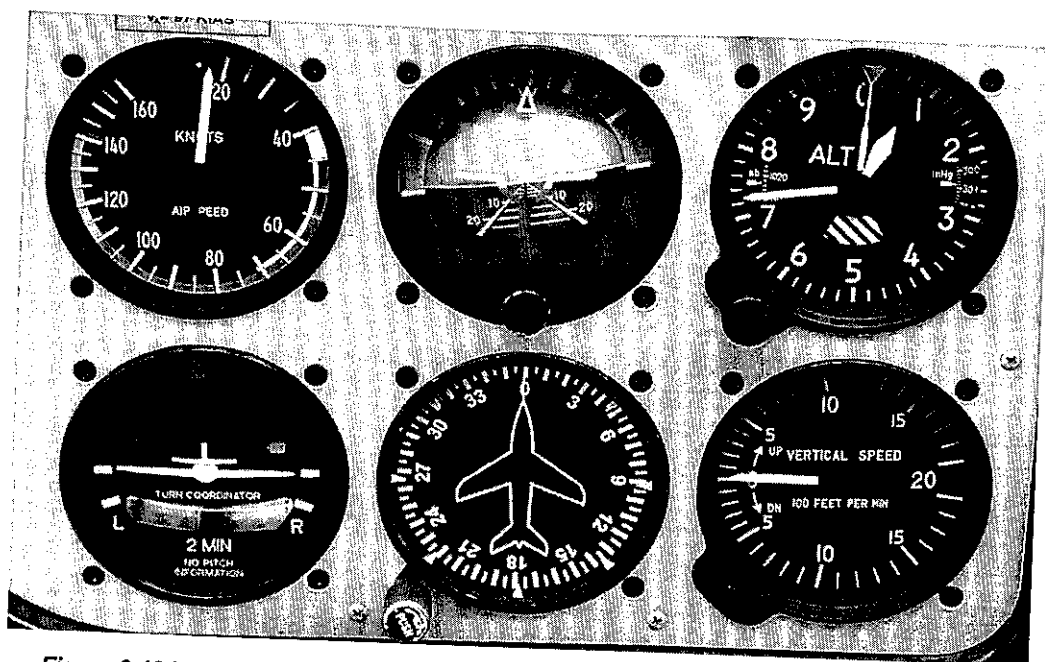
Figura 3.18 I quattro strumenti evidenziati in grassetto, i più importanti, formano la caratteristica configurazione a T, in cui l'Orizzonte Artificiale è in alto al centro, con l'Anemometro alla sinistra e l'Altimetro alla destra; l'asta della T è completata dal Direzionale, situato sotto l'indicatore di assetto. Virobandometro e Variometro sono disposti a sinistra e a destra del direzionale.
