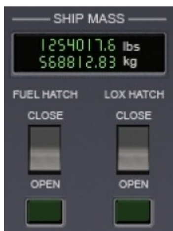
Il display della massa della nave e gli interruttori dei bocchettoni di rifornimento
