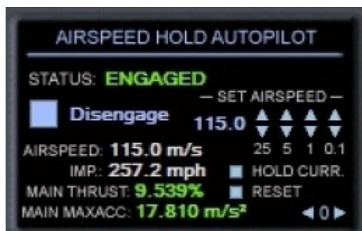
Modalità 0 del Display MDA – Autopilota di Mantenimento Velocità – Attivato
